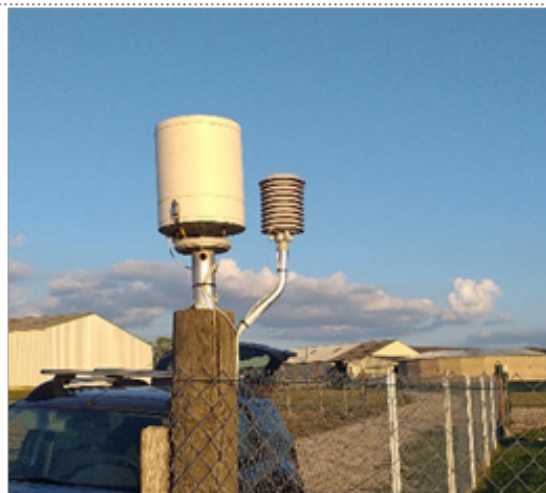
Pluviomètre et station de température
