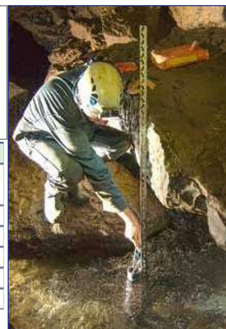
Figure 24 : Le fluorimètre FL24-417 dans la rivière souterraine du Gaougnas-Cabrespine. (Ch. Bès)
