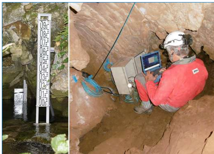
Figure 8 : La vasque extérieure de la source est équipée d'une échelle limnimétrique couvrant la hauteur de battement du plan d'eau (3 m). Un conduit fossile permet d'abriter en toute sécurité les installations de suivi en continu (clichés Ch. Bès, JC Gayet)
