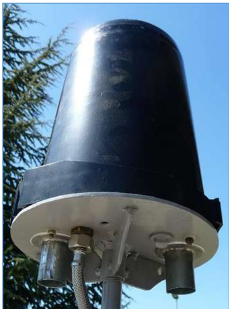
Figure 1 : Le pluviomètre est fixé sur une platine en haut du mât. Les rallonges fabriquées en zinc et collées conduisent l'eau évacuée par l'auget en diminuant l'effet des rafales de vent. Le flexible tressé protège le câble de transmission de la gourmandise des rongeurs.
