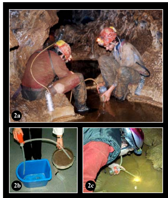
Figures 2a-c — Matériel de prélèvement : 2a, Filtrage du résidu de pompage (photo : C. Boudsocq) ; 2b, Pompe à main ; 2c, Aspirateur à bouche (photo : J. Rodriguez). 2b & 2c proviennent du site http://www.pascalis.project.org
