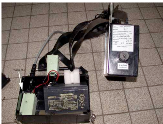
Figure 2- Montage d'origine du matériel de pêche électrique DEKA. Pour l'expédition seul le boîtier de transformation est conservé. La batterie est remplacée par celle utilisée pour les perforateurs. L'anode est remplacée par un cercle en ruban acier souple qui peut être fixé sur un bambou servant de canne. Le montage conserve toutefois un coupe-circuits. L'ensemble pèse moins de 4kg et tient dans un bidon étanche de 15l.
