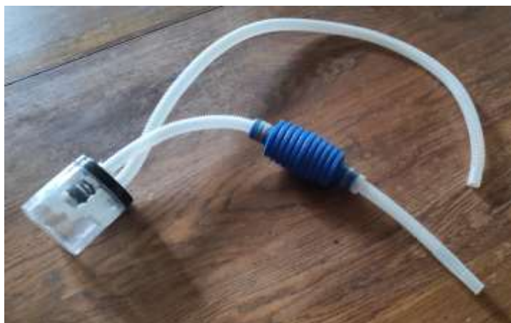
Aspirateur artisanal fabriqué à l'aide d'un système servant initialement à siphonner les aquariums.
