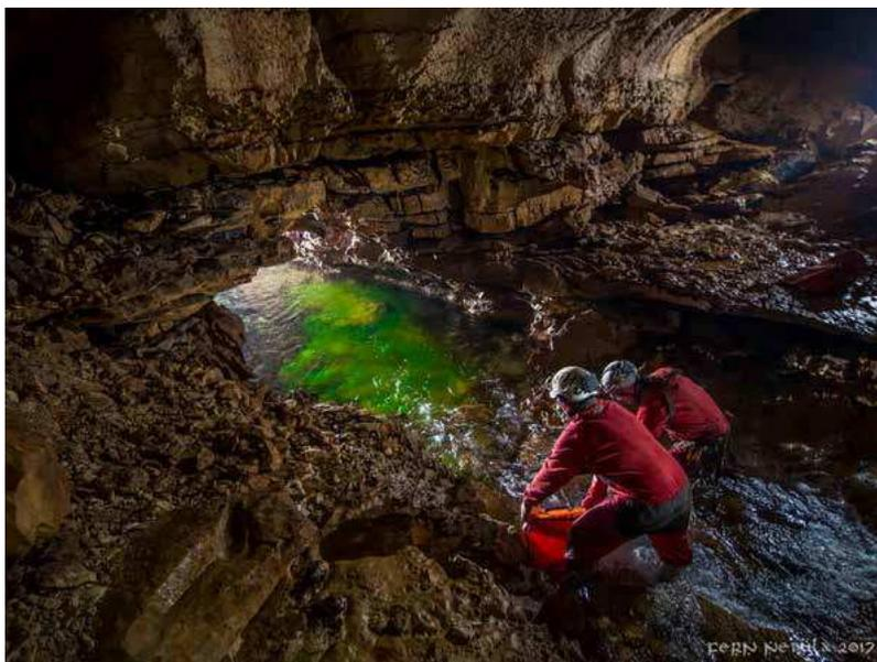
Figure 4 : mesure de débit à la fluorescéine à l'amont de la base des puits (photo : Florian Luciano)
