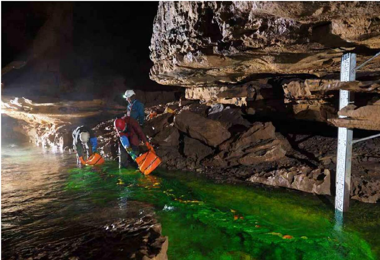
Figure 1 : injection de fluorescéine à la base des puits (photo : Vincent Schneider)
