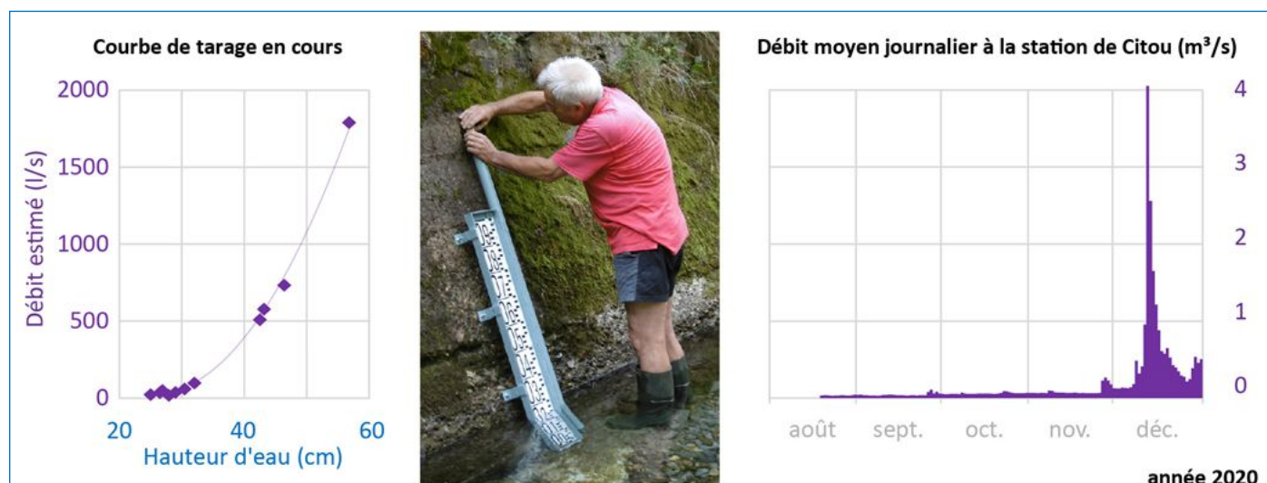
Figure 4 : La station hydrométrique sur l'Argent Double à Citou. La courbe de tarage en cours (gauche), élaborée sur 12 jaugeages entre 25 et 60 cm de niveau d'eau et 30 l à 1800 l/s de débit permet d'obtenir l'hydrogramme de la rivière (droite).
