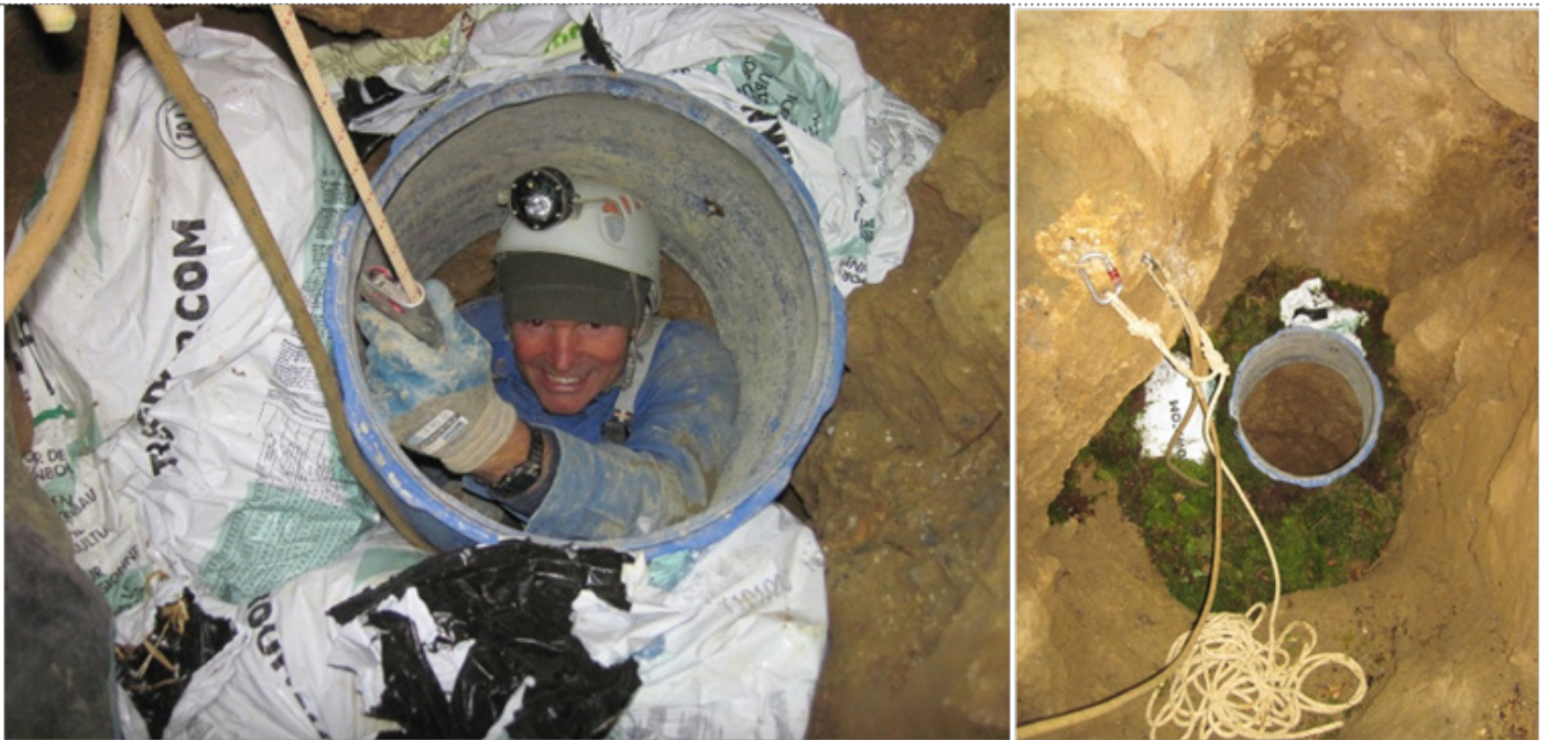
Fig. 7 et 8 : Mise en place des sections de calibration au Trou du Vent et au Chandelier (clichés L. Hermand)
