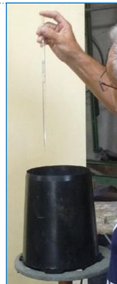
Figure 3 : On laisse s'égoutter 50 ml d'eau de la pipette sur un bord du collecteur.
