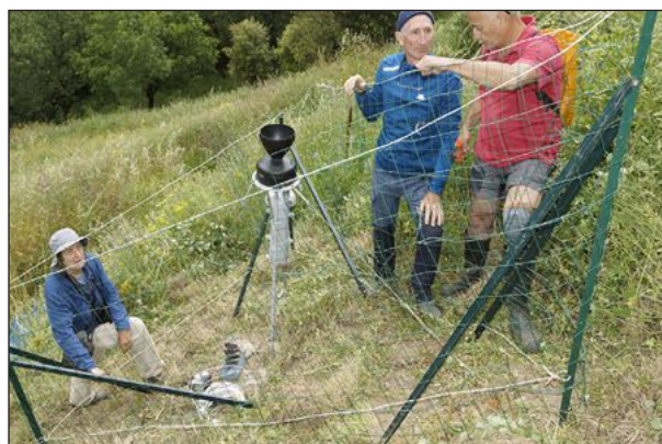
Figure 14 : à 473 m d'altitude, le pluviomètre automatique d'Argentières est représentatif de la moyenne des pluies collectées par le bassin d'alimentation (cliché Ch. Bès).
