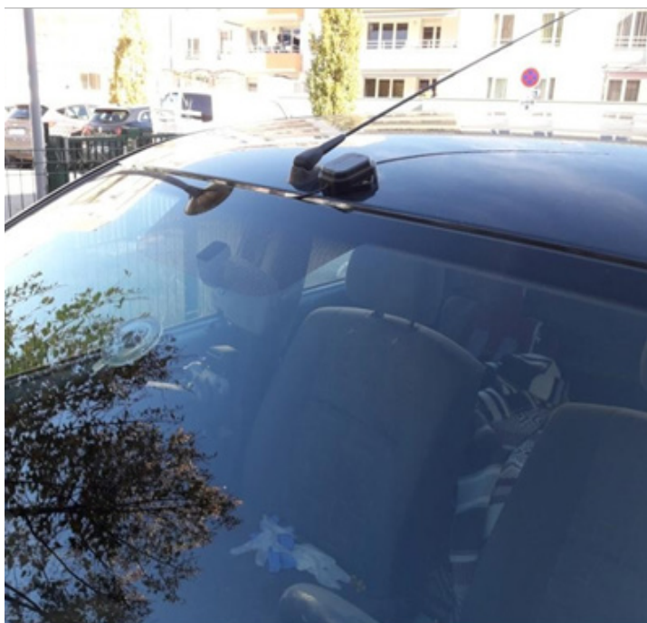
Figure 1 L'antenne GPS est à droite de l'antenne classique.
