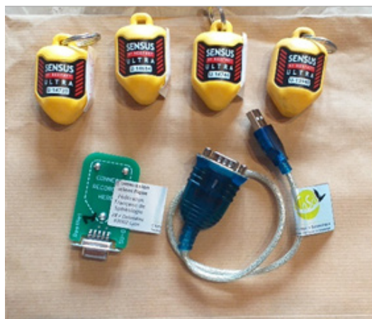
Sondes de pressions « Reefnet » et leur périphérique de programmation
