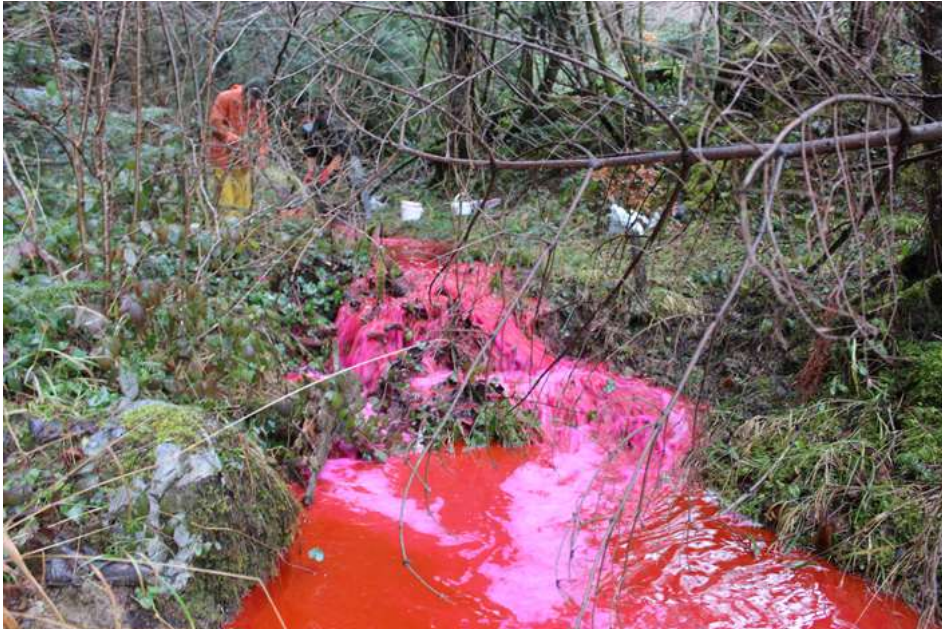
Injection de sulforhodamine B à la perte du Sarrat de l'Étreuil
