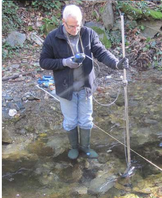
Fig. 3 : Le pluviio-thermomètre automatique installé à Mazouau pendant la durée de l'expérience en haut, la sonde de niveau Hobo prête à être installée dans l'Œil d'Arros au centre, jaugeage de débit dans le ruisseau de l'Artiguette en amont de l'Œil d'Arros en bas. (Photos CDS11 - CDS65).
