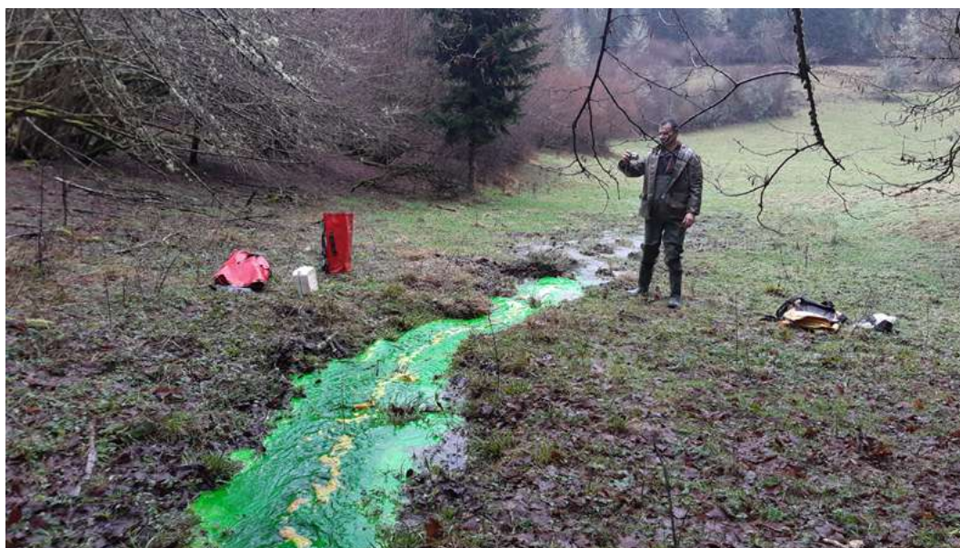
Injection de fluorescéine à la perte de Coume Froide
