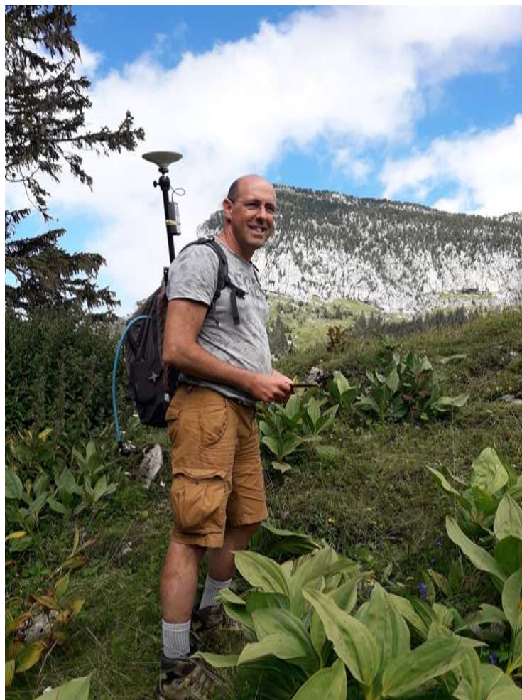
Figure 8 Récepteur SparkFun RTK Express avec antenne SparkFun TOP106 sur trépied photo avec porteur sur le plateau de l'Alpette.
