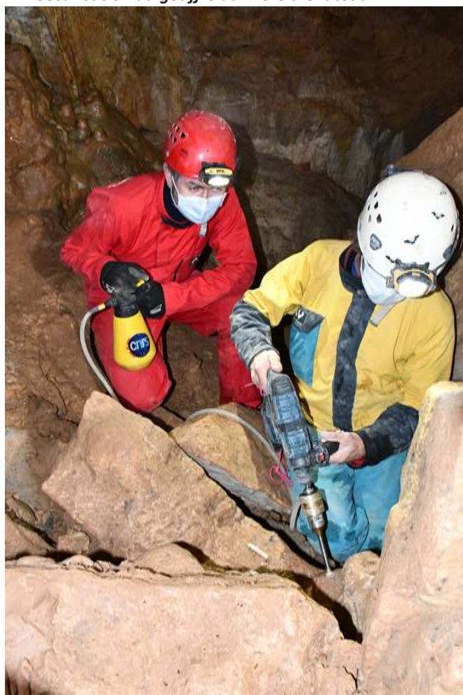
Carottage à Blanot pour datation de spéléothèmes
