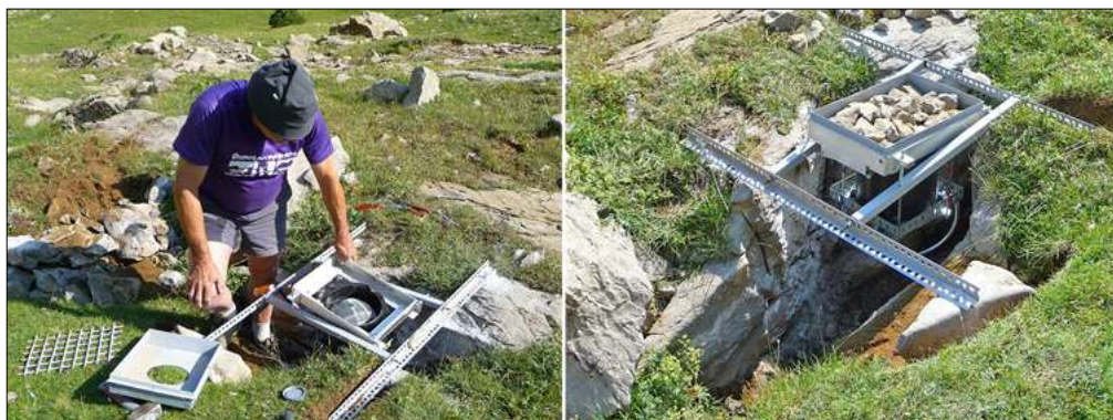
Figure 7 : à gauche mise à niveau de la structure du pluvio-nivomètre de sol du vallon de Monticiello, à droite le système juste avant d'être entouré de blocs. Le thermomètre est plaqué en sous-face du bac en zinc, accessible par l'avant de l'anfractuosité, on devine le flexible métallique protégeant le câble de transmission des marmottes qui l'ont déjà goûté et apprécié. Photo Ch. Bès.
