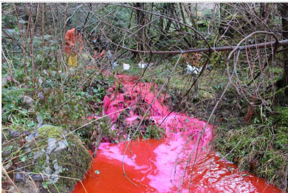
Injection de sulfurhodamine B à la perte du Sarrat de l'Etreuil
