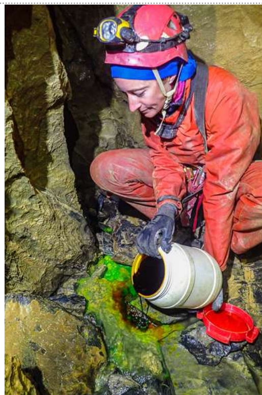
Fig. 7 : Le 15 mai 2021 à midi, 800 g de fluorescéine pré-dilués sont déversés dans le ruisseau souterrain. (Photo P. Degouve)
