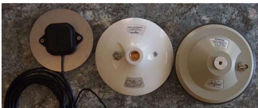
Figure 4 : Antennes GNSS bi-fréquences, de gauche à droite: U-Blox ANN-MB montée sur disque de 120 mm, SparkFun TOP106, Beitian BT-800D, Antenne Drotek DA233 (hélicoïdale) U-Blox ANN-MB SparkFun TOP106 Beitian BT-800D
