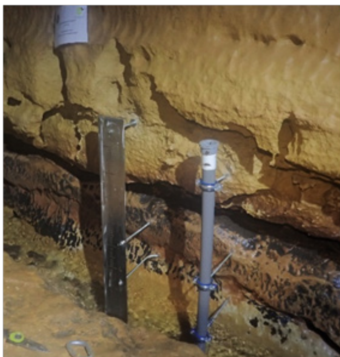
Station hydrométrique de l'Avalanche (réseau du NEUVON) en basses eaux (à gauche) et en hautes-eaux (à droite)
