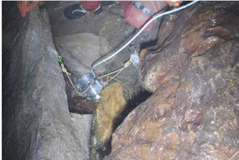
Pose du fluorimètre dans la Muraille de Chine, photos Dav. Cantalupi.
