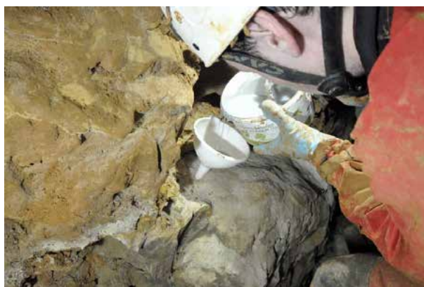
Fig. 8 : test du mortier « Durandal » pour éclater de la roche en place.
