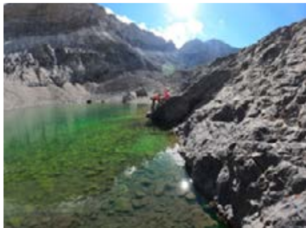
Traçage de l'étang glacé du Mt Perdu. (Photos Gérard Cazenave) Le colorant est visible uniquement à proximité de la perte en bas à droite (couleur vert fluo).
