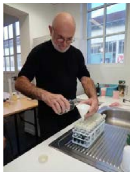
Fig 12 : Extraction de la fluorescéine piégée dans les charbons actifs - Cliché M.C. Delmasure
