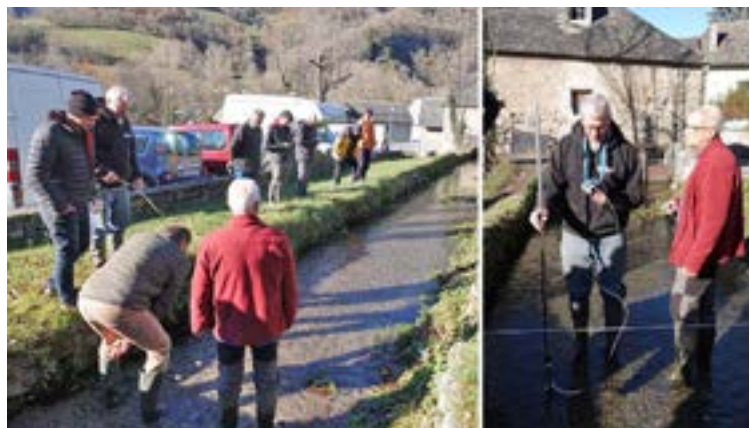
Figure 13 : Au centre du bourg d'Ilhet, démonstration de mesure du débit par plusieurs méthodes dont le jaugeage à l'aide d'un courantomètre-profondimètre mis à disposition par André Tarrisse. (P. Degouve)
