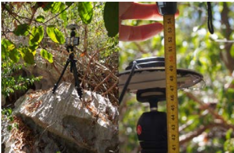
Figure 5 : Rover installé sur le point de départ de la topographie (à gauche) et mesure de la hauteur de l'antenne par rapport au point (à droite)
