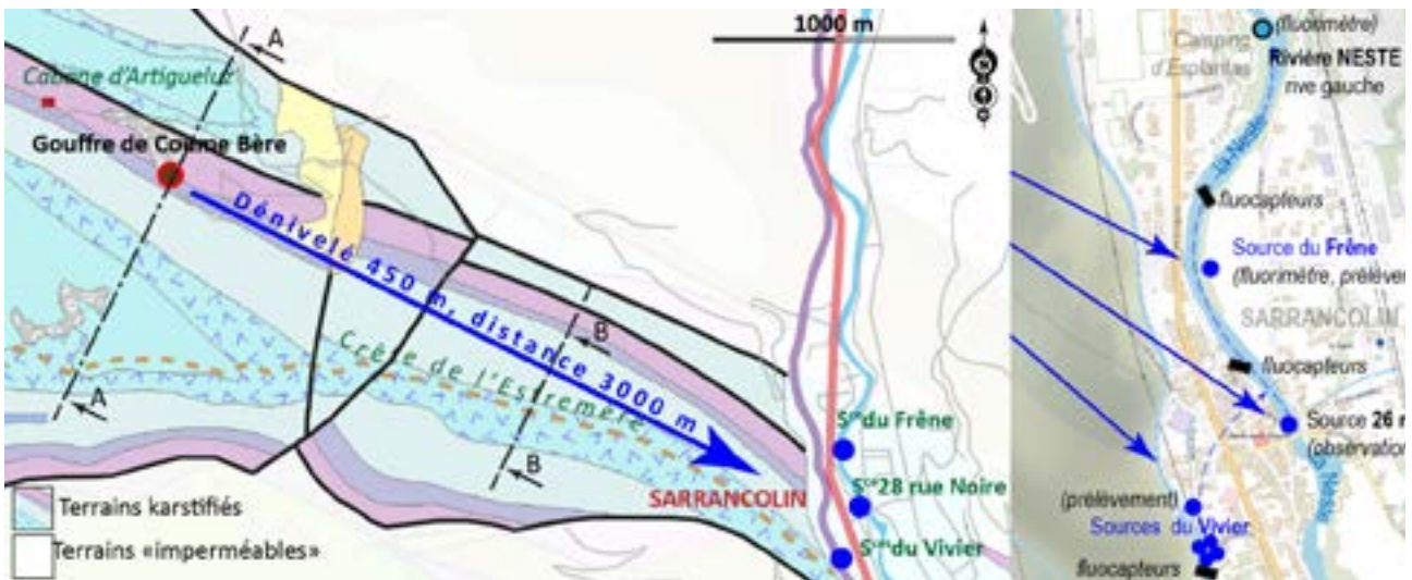
Figure 3 : La relation hydrogéologique entre le gouffre du Bassia et Sarrancolin à gauche, les sites concernés par le traçage dans le village à droite, sur fond cartographique IGN.
