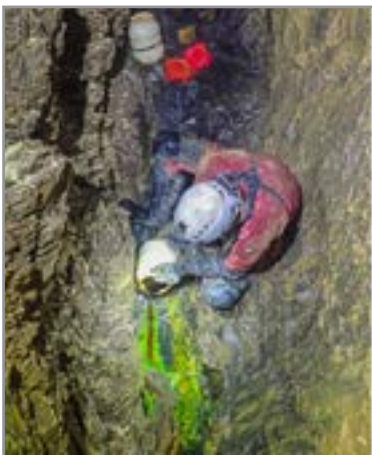
Figure 4 : Damien Vidal injecte la fluorescéine pré-diluée dans le gouffre. (P. Degouve)
