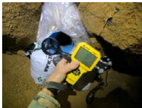
Calibration des passages étroits et mesures du flux d'air en m/sec. (Photos Laurent Hermand)
