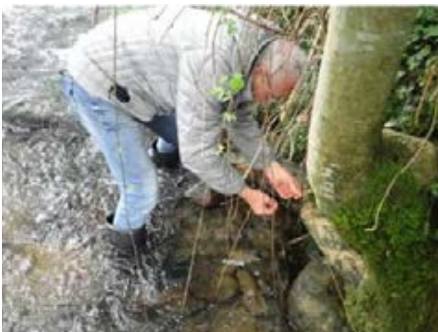
Fig 6: Pose du fluocapteur n°2 dans le ruisseau Behorleguy à Lecumberry – Cliché M.C. Delmasure
