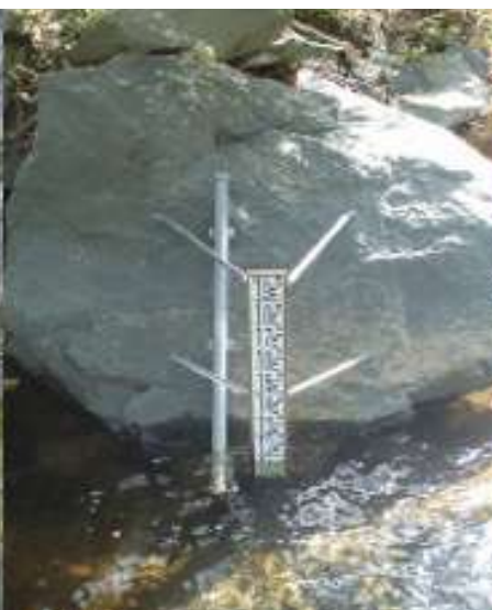
Fig. 4 : sous la cascadelte chutant d'un redan des grès de Marcory, 550 mètres en amont de la source de Laïdoux, la station de l'Éperon mesure, enregistre et transmet à distance les informations d'une sonde multiparamètres Keller (pression, température, conductivité électrique).
