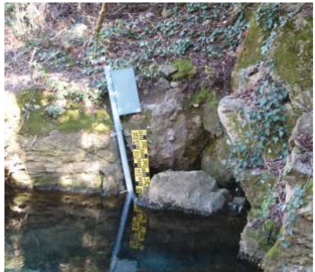
Fig. 11 : la résurgence du Pestil et la station de mesures où sont enregistrés heure après heure le niveau, la température et le conductivité électrique des eaux provenant en grande partie de la rivière souterraine de Cabrespine.
