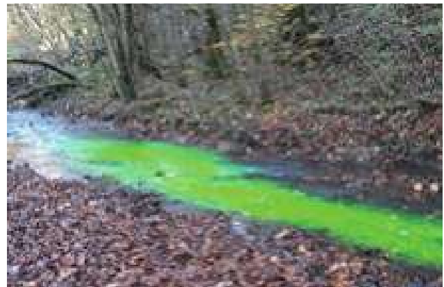
Figure 2 : déplacement du nuage de traceur
