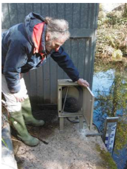
Fig. 6 : l'origine de l'eau de la source de l'ancienne pisciculture de Bibaud n'est toujours pas établie avec certitude, elle est suivie par une sonde auto-compensée CTD-OTT (datas non télétransmises).
