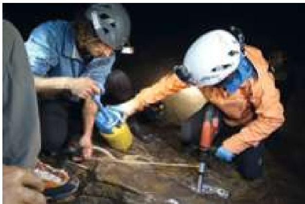
Carottage d'un plancher stalagmitique dans la grotte de Lombrives.
