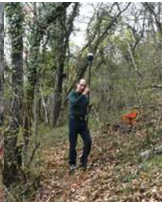
Figure 11 : grotte des Furtins, à Berzé-la-Ville, relevé au dGPS, de la position des électrodes.
