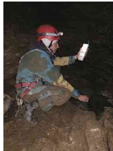
Figure 6 : Mesure de température et conductivité
