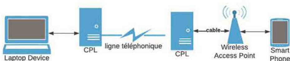
Figure 2 : Système de transmission des vidéos entre un smartphone « webcam » et le PC du commandement SSF
