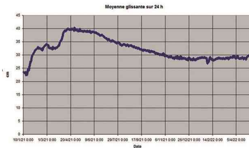
Figure 5 : Pression relative au niveau de la sonde basse ; moyenne glissante sur 24 h.
