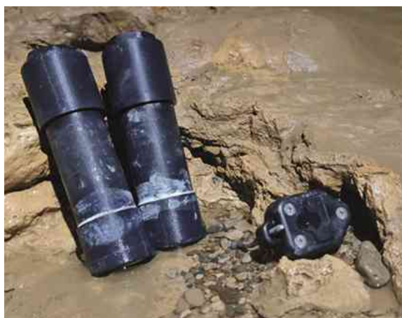
Figure 1 : Mise en place de nos deux PressTemp et d'un ReefNet
