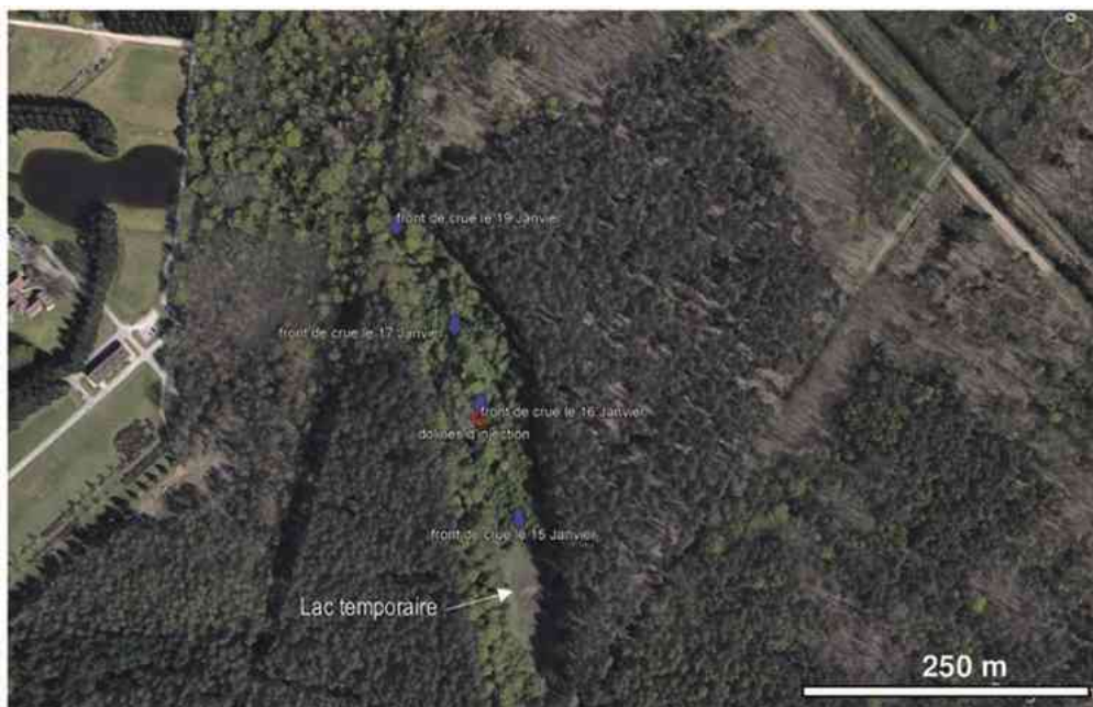
Figure 3 : Vue satellitaire du secteur d'injection : le ruisseau de Limère arrive du sud et se propage progressivement vers le nord pendant les crues jusqu'à être complètement absorbé par les dolines. Le point d'injection est indiqué par le cercle rouge.
