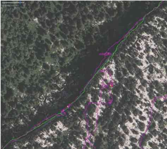
Figure 6 : trace RTK (en vert) et trace GPS Garmin Etrex 30 (en violet)
