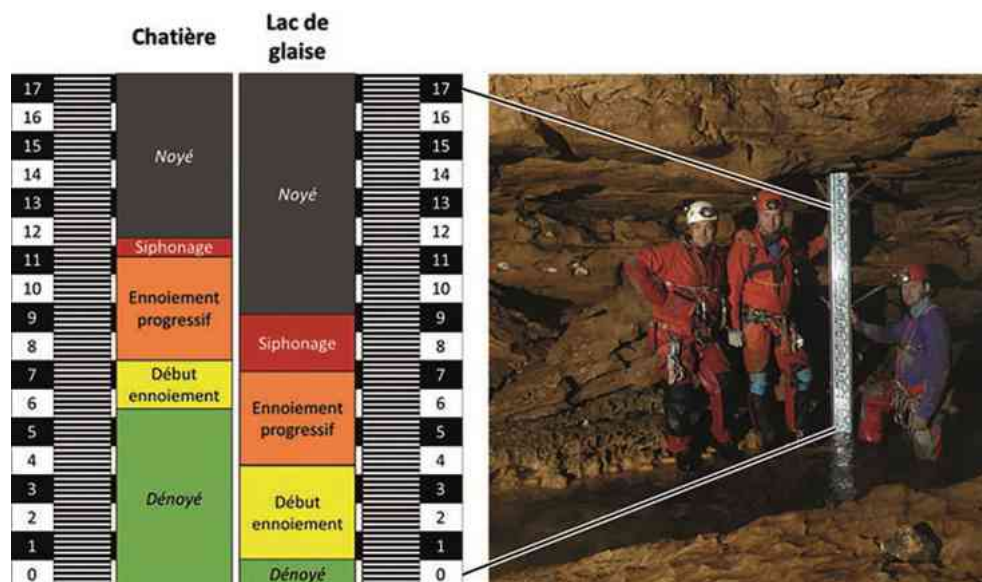
Figure 2 : Etats de la Chatière et du Lac de glaise de la rivière souterraine du réseau de Francheville (Côte-d'Or) vis-à-vis du niveau d'eau observé à l'échelle (graduée en décimètres). Autour d'environ 50 cm la galerie du lac de glaise a tendance à s'ennoyer progressivement.
