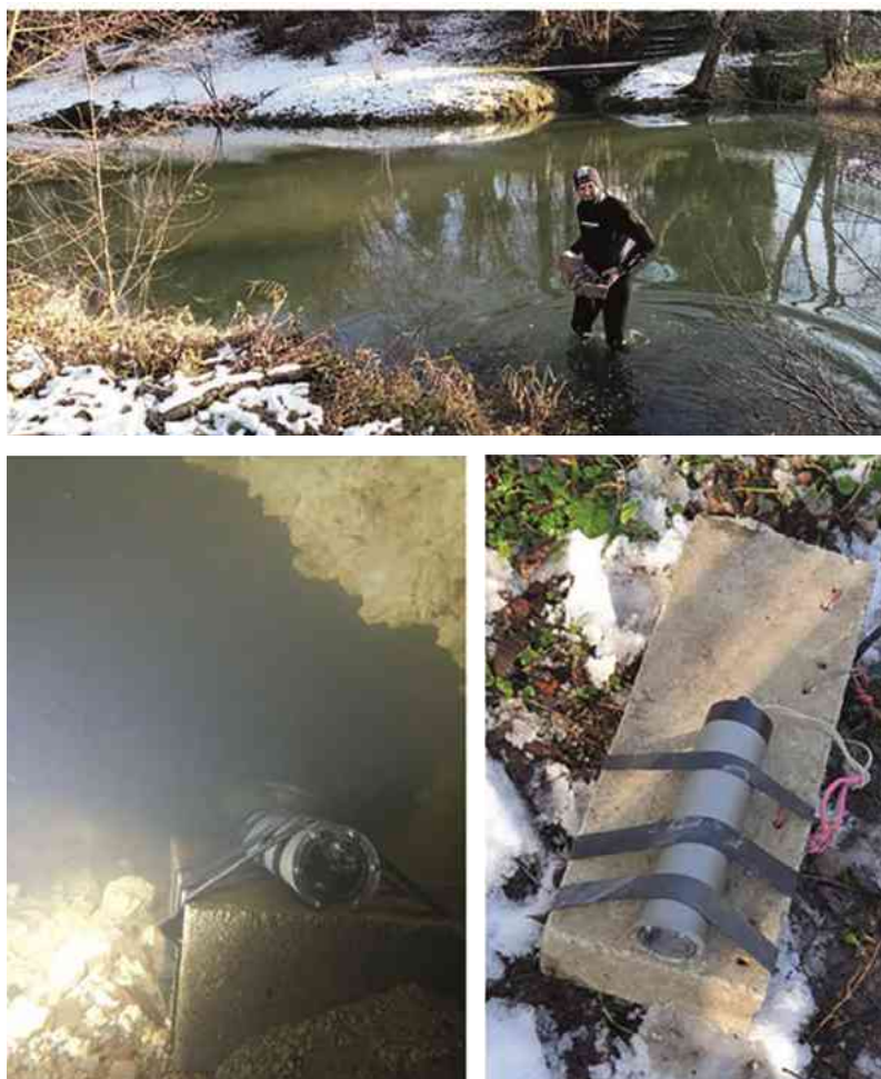
Figure 4 : Mise en place du fluorimètre STREAM à la source de l'Archer aval le 18 janvier après-midi
