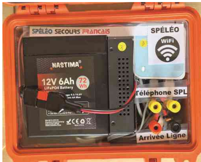
Figure 12 : Exemple de réalisation avec une batterie LiFePo4 de 72 Wh qui permet une utilisation intensive sur plus de 24 h. La batterie possède un BMS (Batterie Management Système) qui protège des fortes décharges quand la batterie est vide.
